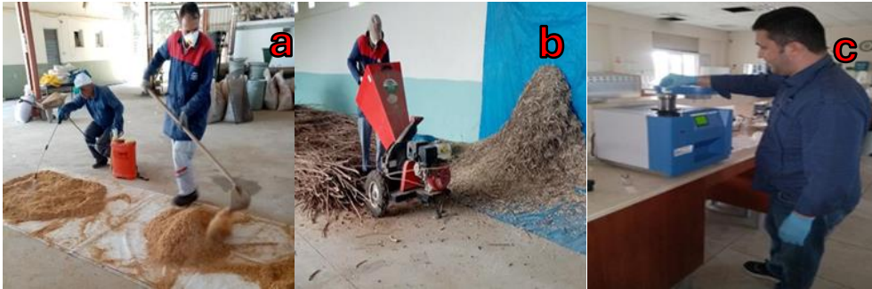
Şekil 2.2.1. materyal nemi ayarlaması (a), Materyalin parçalanması (b), Isıl değer tayini (c)
