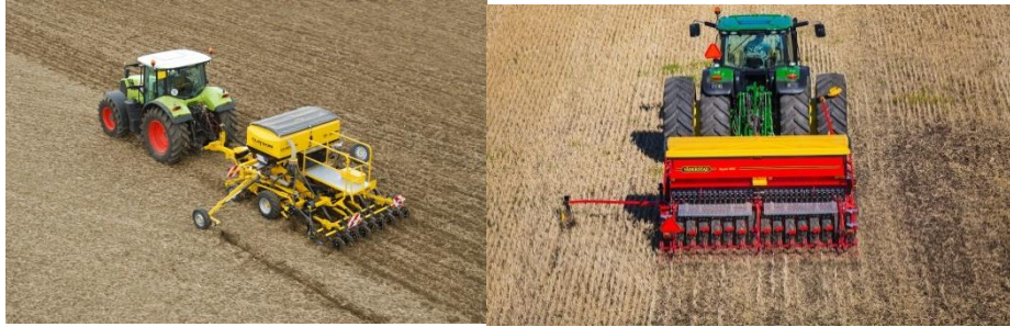
Şekil 5. Sıfır toprak işleme (direk ekim) ve makineleri (URL-3, URL-4)
