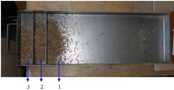
Şekil 7. Ayırıcı tablada Gerilim1 seviyesinde tohumların üç kısma ayrılmış durumu (1. Kısım-1: Bantın ön kısmı ve banta yapışık geriye giden tohumlar, 2. Kısım-2: Orta bölümde toplanan tohumlar, 3. Kısım-3 orta kısmın ilerisine ayrılan tohumlar)
